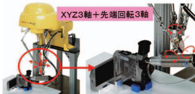
6軸を活かしたねじ締め作業
