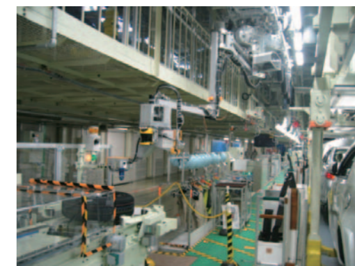
導入したスペアタイヤ自動搭載ロボット (トヨタ自動車 高岡工場)
