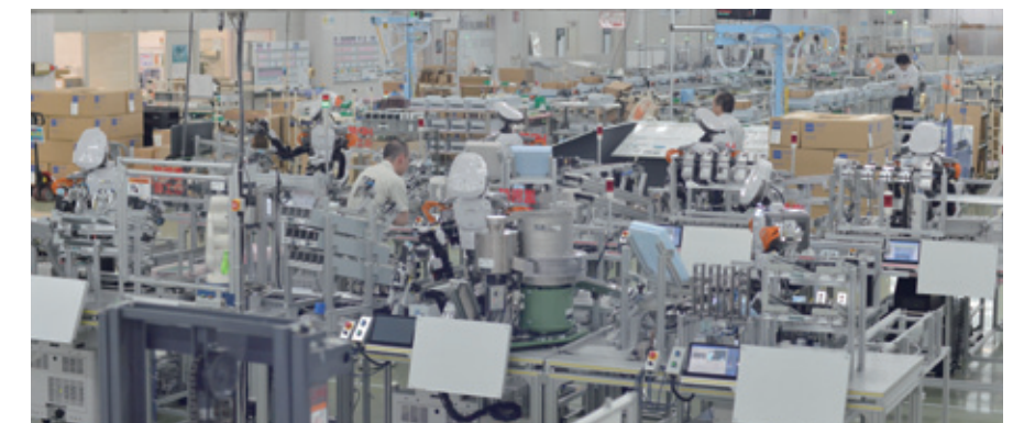
NEXTAGE7台によって構築された新しい組立ライン
