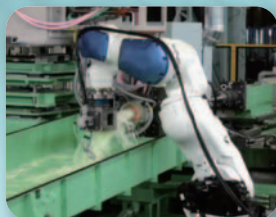
ロボットの自在性を活かした 「3次元鋼管曲げ(3DQ)ロボット」 新日鐵住金株式会社/日鉄住金鋼管株式会社/ 日鉄住金プラント株式会社/株式会社安川電機
