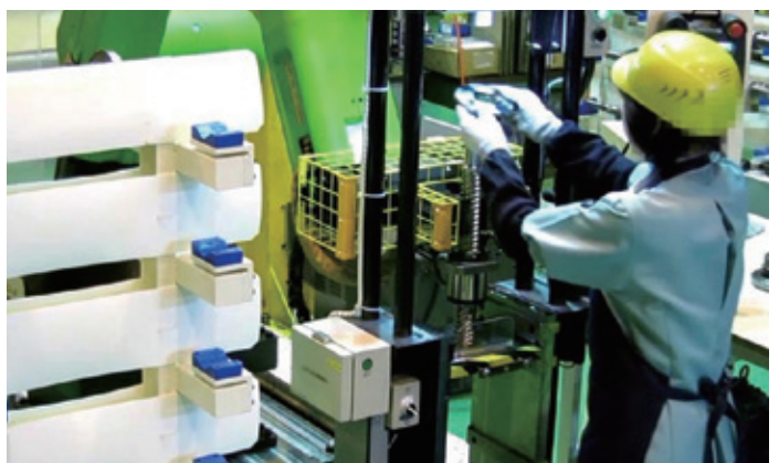
協働ロボットと作業者によるボールねじユニット組立の協働作業
