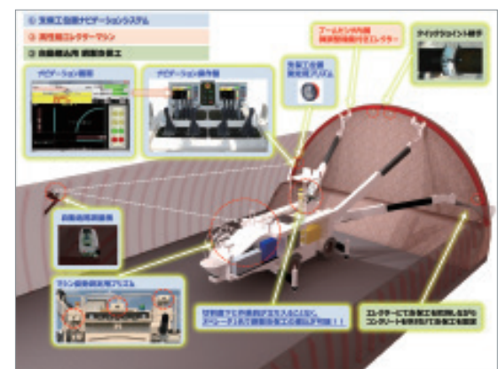
鋼製支保工建込みロボット概念図
