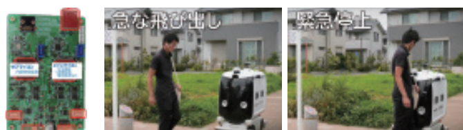
機能安全ユニットと自動搬送ロボット ハコボ®の緊急停止
