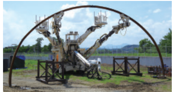
鋼製支保工建込みロボット全景
