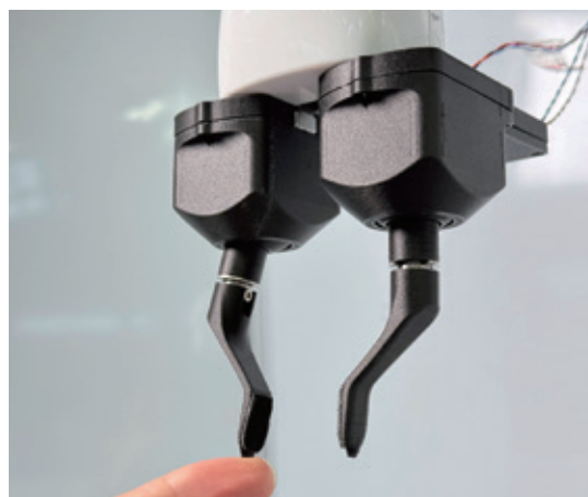
近接覚センサーを利用したバラ積みピッキング用ハンド
