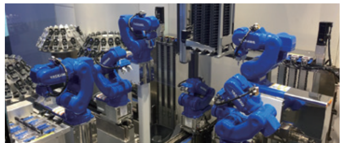
上下左右に配置した高密度で高速な組立てラインの構築
