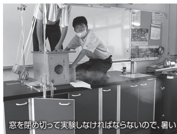
空気砲の実験。穴の大きさを変えて空気の流れを計る
