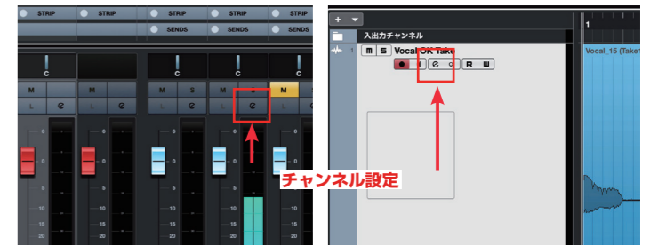
▲トラックリストか MixConsole の「e」ボタンを押すと、プラグインエフェクトの設定などをカスタマイズするための、チャンネル設定画面を開くことができます。
