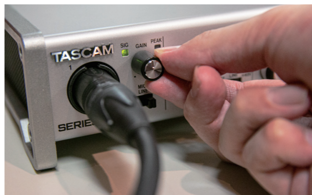
▲CLIP インジケーターが赤く点灯しないように注意！コンデンサーマイクを使う場合には、+48V（ファントム電源）を ON にしましょう
