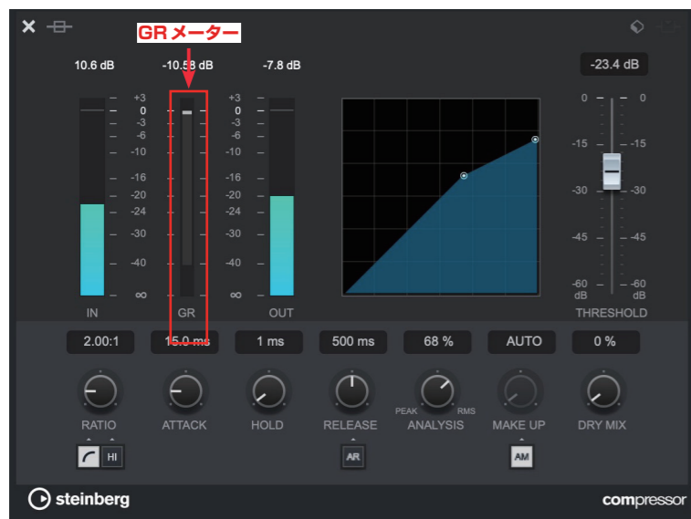
▲ Cubase LE のチャンネルストリップに内蔵されているコンプレッサー。音がどの位圧縮されているのかを視覚的に確認することができます。
