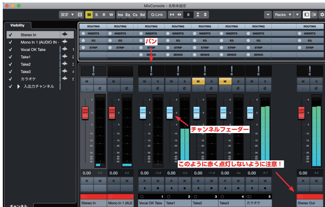
▲マスターがクリップすると、Cubase LE 上で再生しているときには問題なくても、書き出す際に音割れが生じるので避けるのが基本です。また、Stereo Out のフェーダーは原則として動かさないようにし、音量が大きいときには各チャンネルのフェーダーを調整します。
