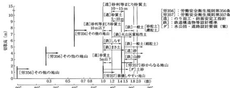
図2-2-5 (c) のり面勾配の基準・標準の比較 (軟らかい土砂) *)
