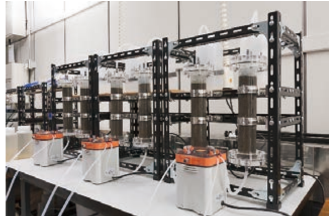
図 4 上向流カラム試験装置
