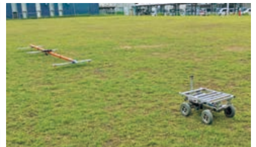
図1 UGVEMシステム(右:UGV,左:CMD)
