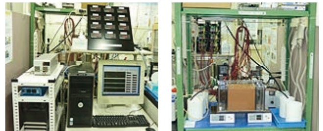
図 5 動電学的浄化試験システム (左: 制御部, 右: 土槽)
