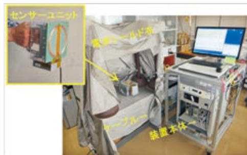
図1 探査深度約1cmのセンサーユニットを用いた実験風景
