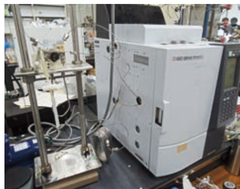
図1 非メタン炭化水素濃縮測定装置
