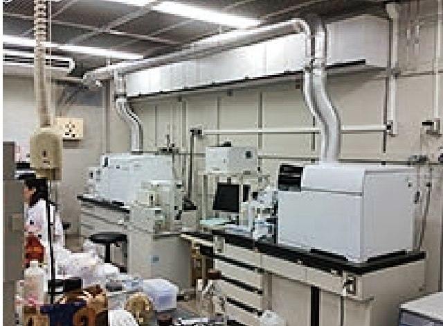
図 2 重金属類の高精度分析が可能な ICP-MS
