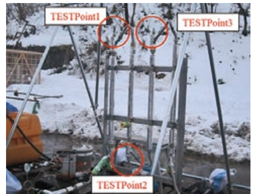
図1 小型ループ式材料腐食試験装置
