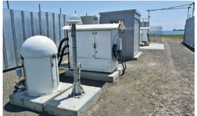
図1 苫小牧重力観測点の外観(手前および奥にある上部が半球状のエンクロージャ内に超伝導重力計を設置)
