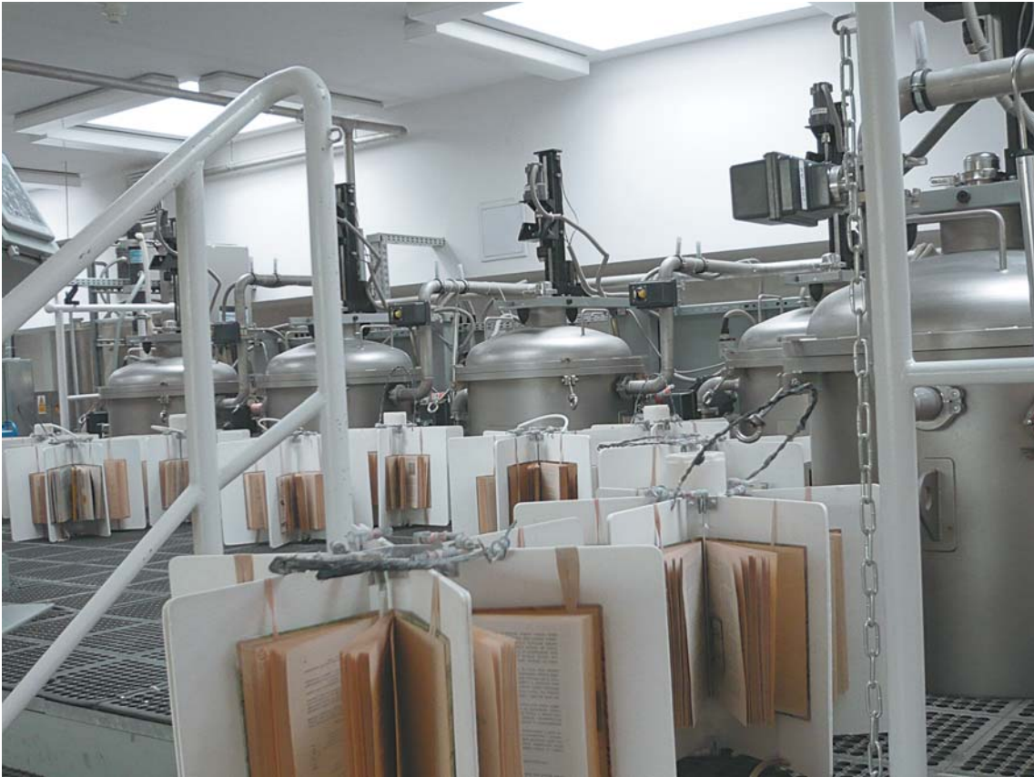
Instalacja Bookkeeper do odkwaszania ksiązek
