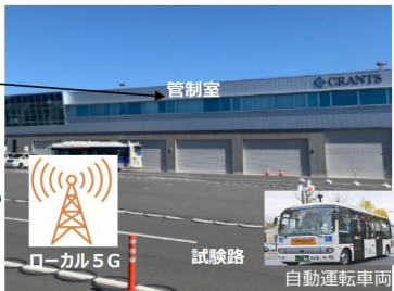
【遠隔監視・操作】 管制室をローカル5Gエリア化、フルHDモニターにて目視（高速・大容量）
