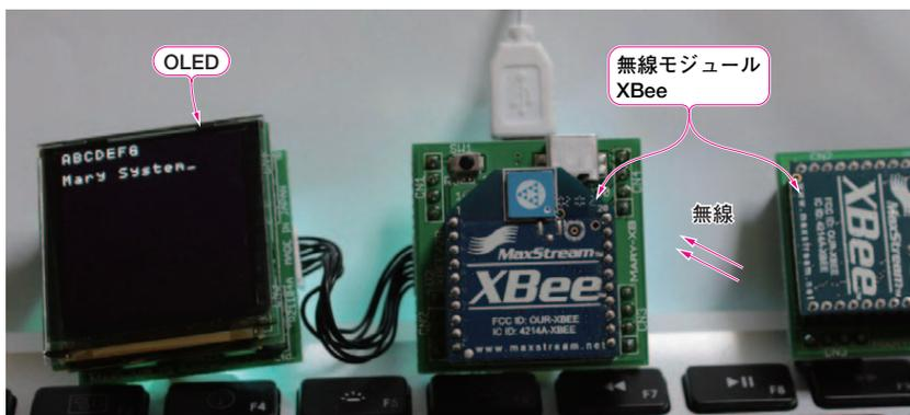
写真6 XBee無線モジュールの接続実験
