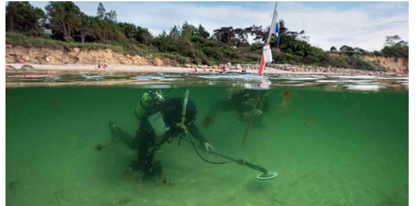
Suche der Angelköder mit Metall-detektor. Die Positionierung erfolgt per Datenlogger.
