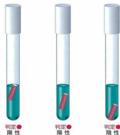
ガストラップチップによるガス産生の判定
