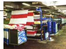
高効率テンター (低環境負荷型の生地仕上げ乾燥設備)
