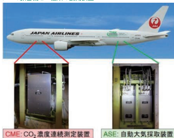
JALの旅客機と2種類の観測装置
