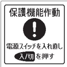
マッサージ動作中や、メカ(もみ玉)の移動中に誤ってメカ(もみ玉)と座部の間からだや物がはさまってしまったとき、保護機能がはたらき少し上に上がってから停止します。そのとき、リモコン液晶中に『保護機能作動 電源スイッチを入れ直し **入/切** を押す』が表示されます。保護機能がはたらいた原因を取り除き、表示内容に従って、再度電源を入れなおしてください。
