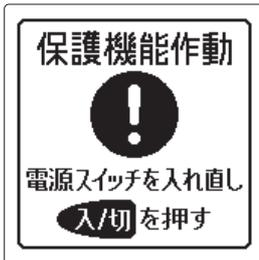
マッサージ動作中や、メカ(もみ玉)の移動中に誤ってメカ(もみ玉)と座部の間からだや物がはさまってしまったとき、保護機能がはたらき少し上から止まります。そのとき、リモコン液晶中に『保護機能作動 電源スイッチを入れ直し **入/切** を押す』が表示されます。保護機能がはたらいた原因を取り除き、表示内容に従って、再度電源を入れなおしてください。
