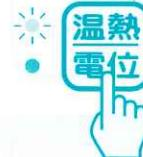
温熱モード終了後、温熱側のランプが消え、自動的に電位側ランプが点灯し、電位モードに切替わります。
