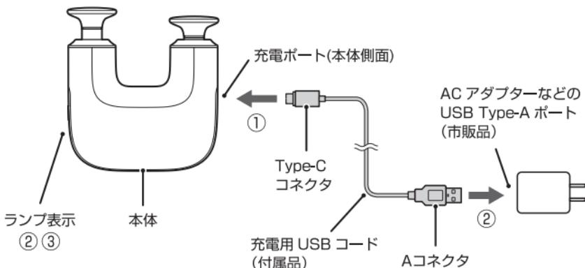
① 本体側面の充電ポートにUSBコードのType-Cコネクタを差し込む。
