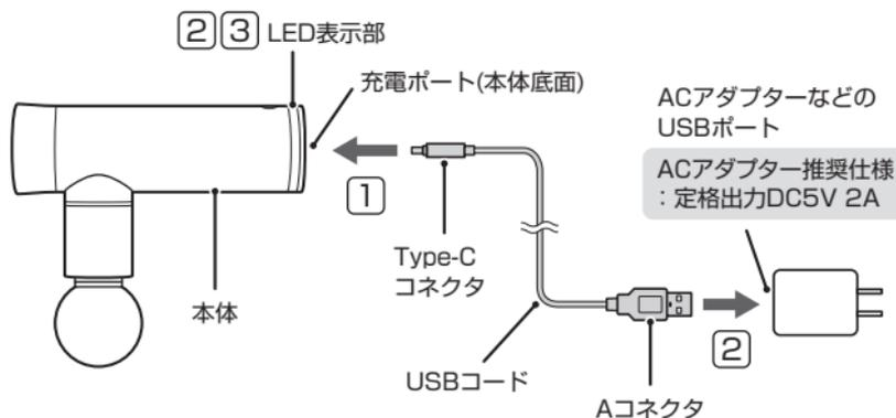
1. 本体底面の充電ポートにUSBコードのType-Cコネクタを差し込む。
