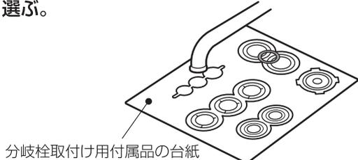
分岐栓締め付けキャップをパイプに通す。
