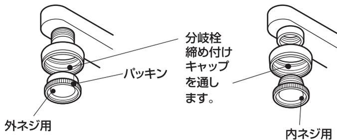
分岐栓を下から水平に当て、分岐栓締め付けキャップを締め付ける。
