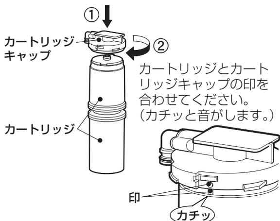
**6** カートリッジカバーを閉じ、浄水モードにして出てくる水が透明になるまで(2~3分間)通水する。カートリッジ内の活性炭の黒い粉末が少し出ることがあります。(カートリッジカバーを閉じないで通水するとカートリッジが浮いて水漏れします。)
