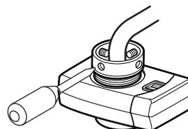
分岐栓本体をビス止め用ナットで締め付けて固定する。
