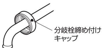
固定用リングをパイプの先端にはめ込む。
