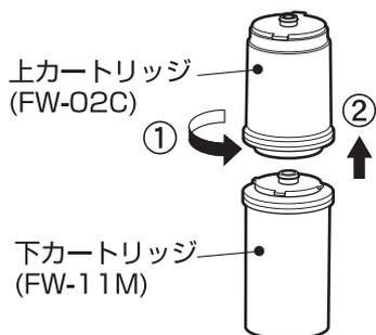
**5** 新しいカートリッジを取り付ける。上カートリッジと下カートリッジの印が合う位置(カチッと音がる)まで回してください。
