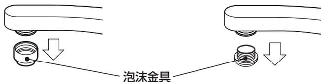
外ネジ用または内ネジ用付属品をコインなどで回して、分岐栓締め付けキャップを蛇口に取り付ける。
