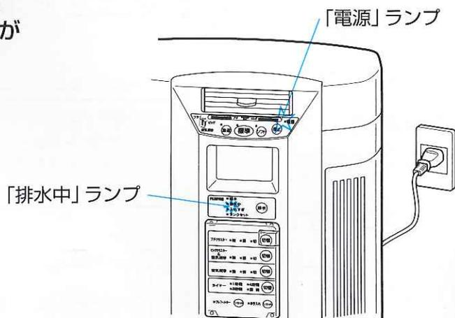
2 タンクカバーを開けて、給排水タンクを取り出し、排水された水を捨ててください。その後、軽くすすいでから水位線まで水道水または指定の酸性水を入れます。
