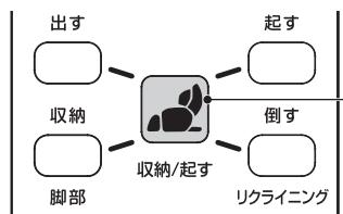
**1** 背もたれ部を起して、脚部を収納するときは、 を長押しします。
