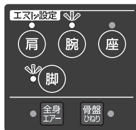
「全身エアー」ランプ消灯 ※肩・腕・脚エアー「入」、座エアー「切」
