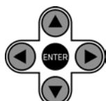
画像表示中に上下左右選択ボタンを押すと、「ROTATING」と表示され画像が回転又は反転して表示されます。
