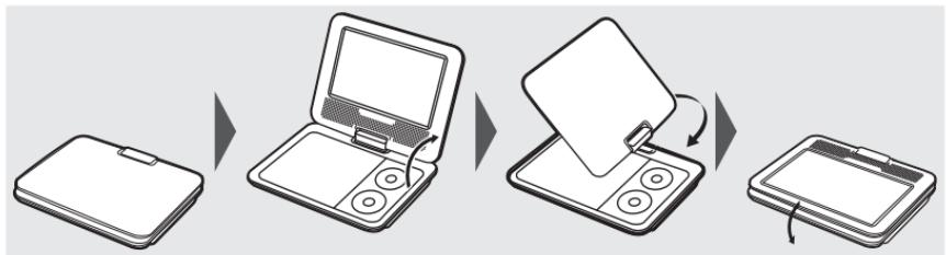
※：液晶画面は水平に回転させてください。傾けたり、折りたたんだ状態で回転させると本体に傷が付く場合があります。
