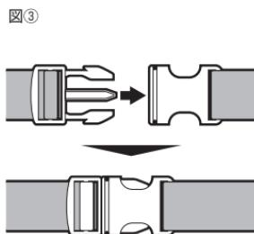
3.本製品を水平かつ動かないように左右のベルトを調整してください。このときベルト
