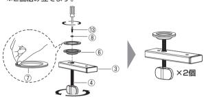
3 クランプ部をフレーム(大)をフレーム固定ネジ (短)で取り付けます。
