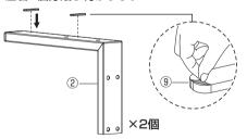
3 フレーム(小)にフレーム固定ネジ(短)でフレーム(大)を取り付けます。
