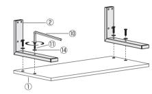
クランプ部を下図の通り組み立てます。※2個組み立てます。
