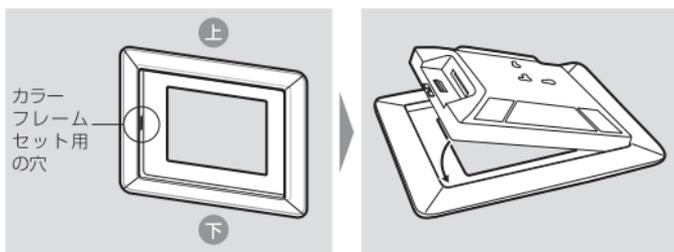
上図のように、カラーフレーム背面から見て、カラーフレームセット用の穴が左側にくるようにし、カラーフレームの上下を確認してください。
