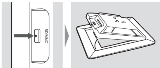
フレーム脱着スイッチを矢印の方向に押すとカラーフレームと本体が取り外しできます。
