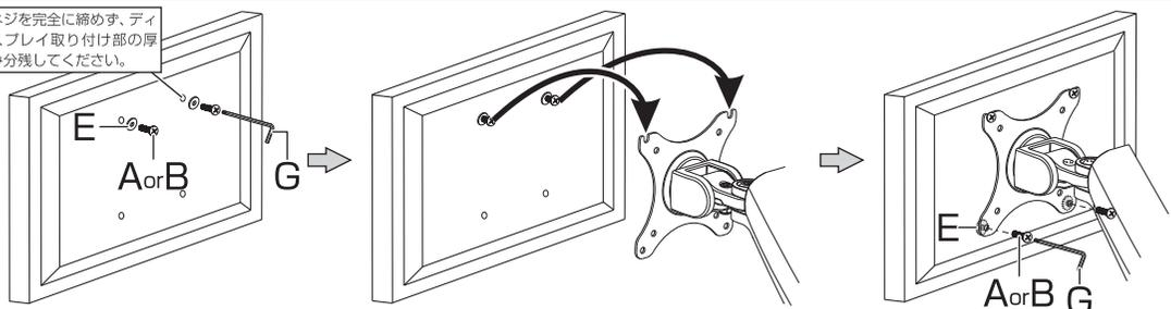
付属のディスプレイ取り付け用ネジ(M4、M5)を使用して、ディスプレイ取り付け部にディスプレイを取り付けます。
