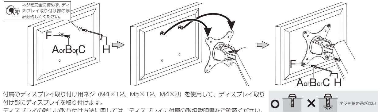
付属のディスプレイ取り付け用ネジ (M4×12, M5×12, M4×8) を使用して、ディスプレイ取り付け部にディスプレイを取り付けます。
