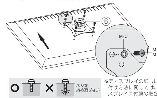
2 アーム部背面のハンドルを一度外し、スタンド部に取り付けた後、アーム部のネジとハンドルを締めて固定してください。
