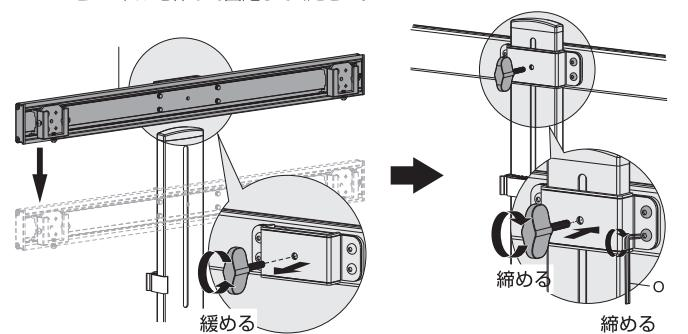
3 スタンドにディスプレイ取り付け部を挿し込み、固定ネジを締めてください。
