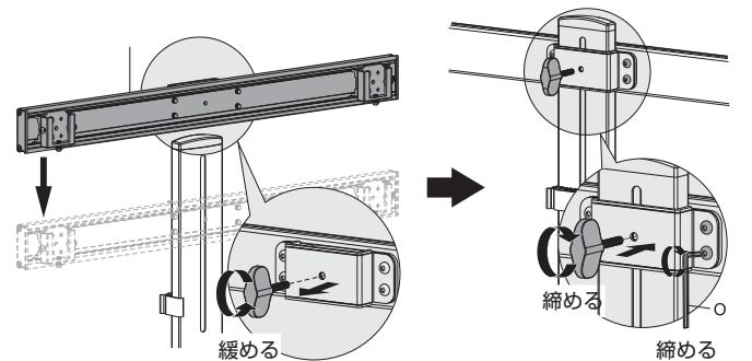
3 スタンドにディスプレイ取り付け部を挿し込み、固定ネジを締めてください。
