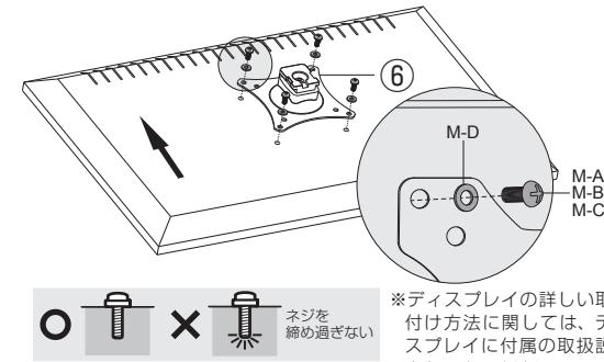
2 アーム部背面のハンドルを一度外し、スタンド部に取り付けた後、アーム部のネジとハンドルを締めて固定してください。
