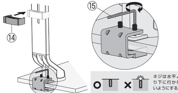
※Cクランプのネジは左右交互に均等に締め付けてください。片方だけを強く締め付けると、締め付け加減にバラつきが発生し、ネジの損傷や不完全な固定の原因になります。
