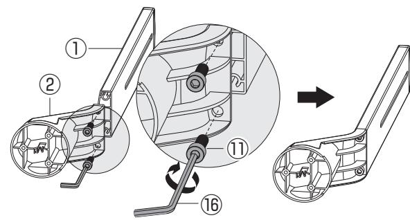
2 スタンド下部とCクランプ用カバーをカバー固定ネジで固定し、その上から滑り止めゴムを貼ります。
