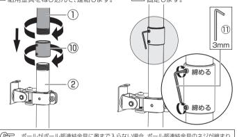
ポールがポール部連結金具に奥まで入らない場合、ポール部連結金具のネジが締まり ポイント すぎている場合がありますので、六角レンチ(3mm)でネジを緩めてください。
