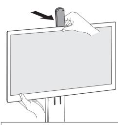
高さを調整する場合は、ディスプレイを支えながら昇 降レバーを手前に倒します。
