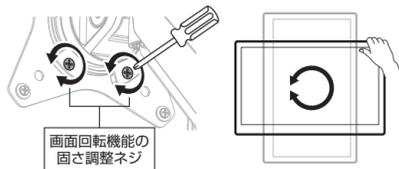
画面回転機能の固定調整は、ディスプレイ取り付け部の上図2つのネジでおこないます。
