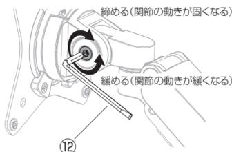
■ガススプリングの固さ調整
