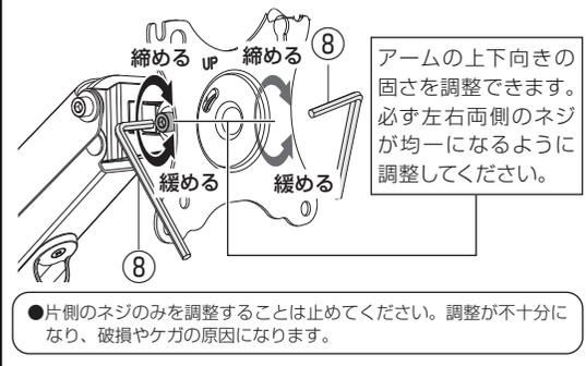
アームの上下向きの固さを調整できます。必ず左右両側のネジが均一になるように調整してください。
