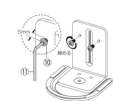
4 取り付ける机の厚さに合わせてCクランプ下部の固定方法を選択してください。
