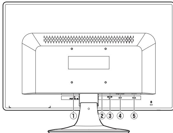
**①:ACジャックコネクタ****④DVI-D端子****②ヘッドホン端子****⑤mini D-Sub15端子****③音声入力端子**
