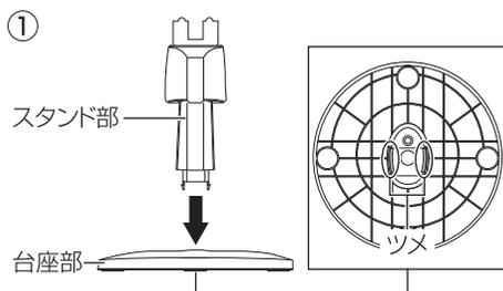
台座部にスタンド部をカチッと音がするまで挿し込み、ツメが固定されている事を確認してください。
