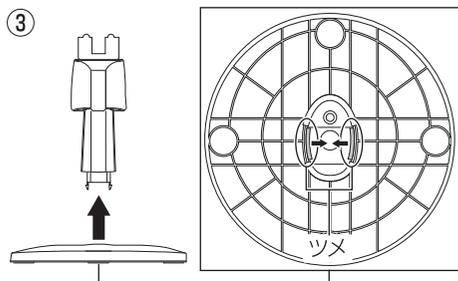
台座部底面のツメ外し、スタンド部を引き抜いてください。
