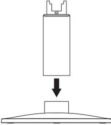
台座部にスタンド部をカチッと音がするまで押し込み、ツメが固定されている事を確認してください。
