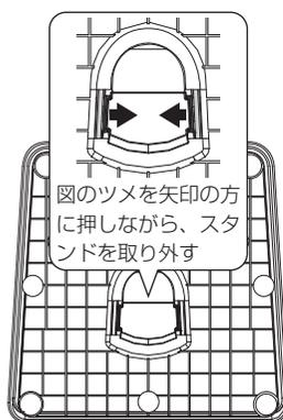
台座の底面にある2箇所のツメを図の方向に押しながらから、スタンドを引いて取り外してください。
