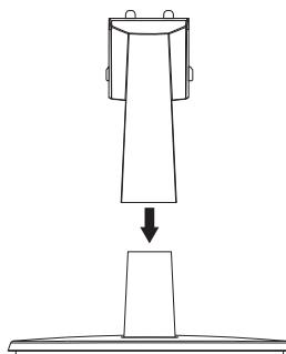
台座部にスタンド部をカチッと音がするまで挿し込み、ツメが固定されている事を確認してください。
