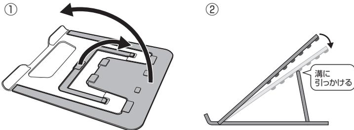
②で角度調整板を引っかける溝によって、天板の角度を調整します。
