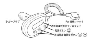
・シガープラグ : 車両のシガーソケットに差し込みます。(12V 車のみ)・電源ボタン : GH-FTC-IPODW/B の電源の ON、OFF を切り替えます。
