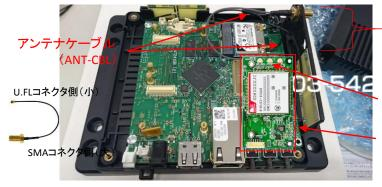
ANT-LTEA(3G/LTE用ホイップアンテナ) ANT-3GA(3G用ホイップアンテナ) いづれかを接続してください。
