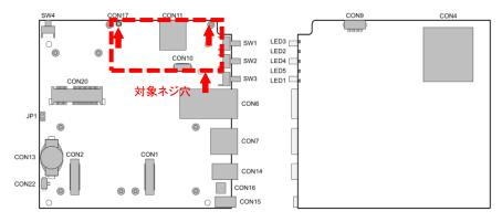
③基板表側(A\_Side)より六角オネジメネジを差し込んで、基板裏面(B\_Side)にてナットで
