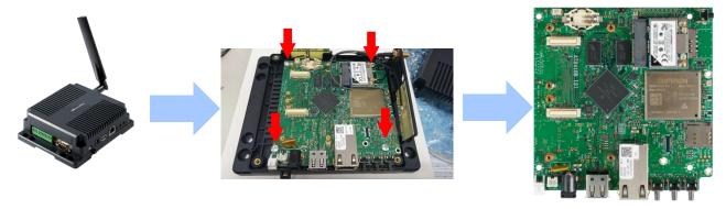
②アドオンボードを取り付けるコネクタ(下記CON10)に合わせて添付品のネジを装着します。(詳細は裏面をご覧下さい。)
