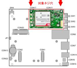
⑤基板を**Armadillo-IOT** ケースに戻し、アンテナケーブルのU.FLコネクタ側(小)をアドオンボードのJ2/J3にそれぞれ接続します。アンテナケーブルのSMAコネクタ側(大)は **Armadillo-IOT** ケースに接続してください。
