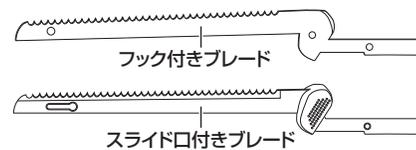
1. ブレードの刃に注意し、フック付きブレードのフックとスライド口付きブレードのスライド口を重ね、フックを通す。
