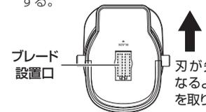
2. ブレードの向きに注意して、本体のブレード設置口にブレードを奥に差し込む。カチッと音がして本体にロックされます。
